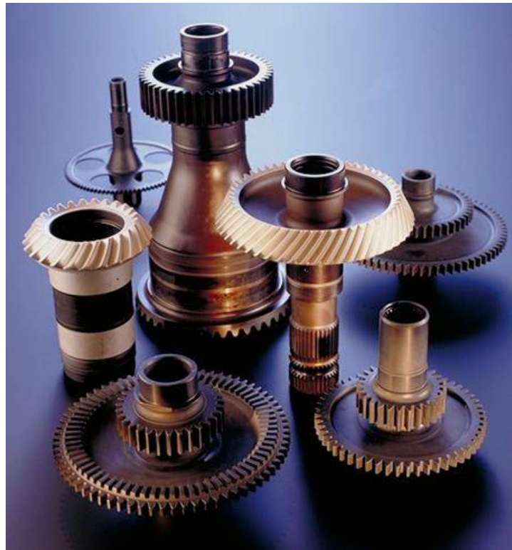
FIGURE 1 – Exemples de pièces de transmission de puissance soumises à des traitements thermochimiques (source : Safran Group).
