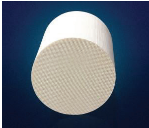
Figure I-5 Monolithe de cordiérite en structure de nid d'abeille.
