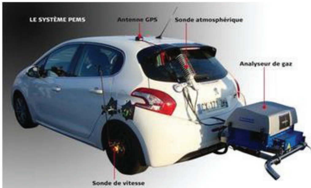
Figure I-3 Présentation du système embarqué 'PEMS' pour les tests en conditions de roulage (RDE). © JF Prevéraud / Gérard Quévrin.
