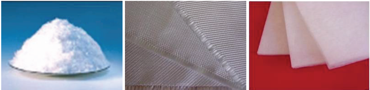
Figure 59 : Fibres de silice pure sous forme de fibres coupées (gauche), de tissu (milieu) et de feutre (droite) commercialisés par la société Final Advanced Materials [111].
