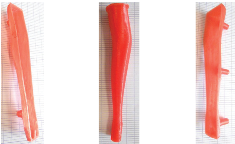
Figure 113 : Moules externe et interne en PLA, de la partie abdominale. De gauche à droite : 1 ère partie du moule externe avec zone d'injection, moule interne, 2 nde partie du moule externe avec zones de surplus.
