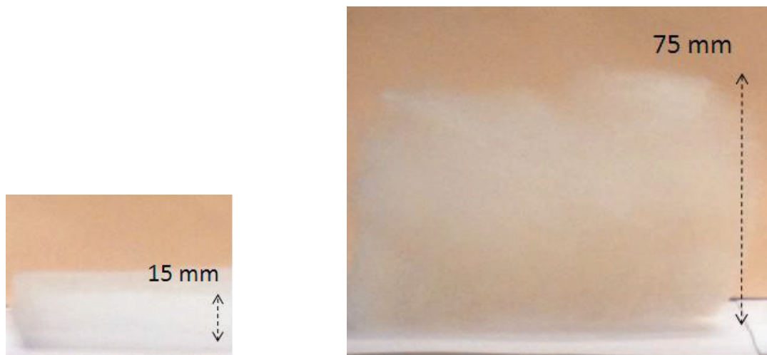
Figure 60 : Effet du traitement thermique du feutre de silice. A gauche, feutre de silice avant traitement ; A droite, feutre de silice après traitement. Les flèches en pointillés indiquent l'épaisseur des feutres.
