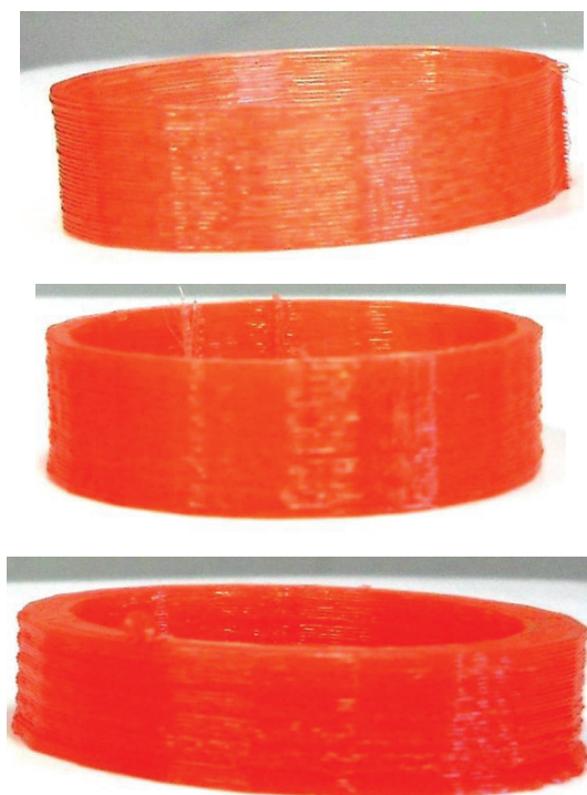
Figure 85 : Résultats d'impression dans l'étude de l'épaisseur de couche. Résolution d'impression 250 \mu\text{m} à une température de dépôt de 195°C. En haut: épaisseur = 0,55 mm ; au milieu : épaisseur = 1 mm ; en bas : épaisseur = 2,3 mm.
