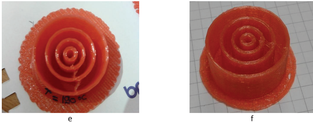
Figure 88 : Résultats d'impression de la pièce multitube, à différentes températures de dépôt : a = 170°C ; b = 175°C ; c = 180°C ; d = 185°C ; e = 190°C ; f = 195°C. Impression en filament double collé, résolution de couche 250 \mu\text{m} .
