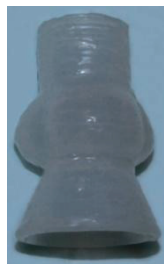
Figure 27 : Fantôme de la racine aortique en silicone RTV1 (gauche) par impression 3D à projection de matière (droite) [93, 99].
