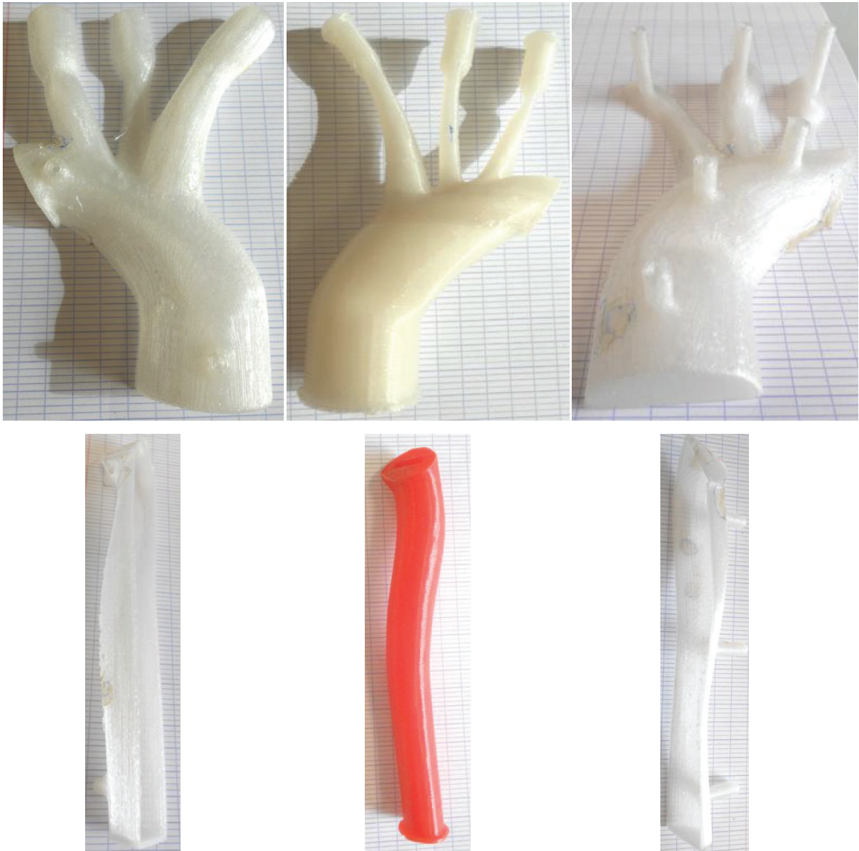
Figure 119 : Moules externe et interne en PLA. De haut en bas : Partie supérieure de l'aorte (ascendante + crosse), partie descendante. De gauche à droite : 1 ère partie du moule externe avec zone d'injection, moule interne, 2 nd e partie du moule externe avec zones de surplus.
