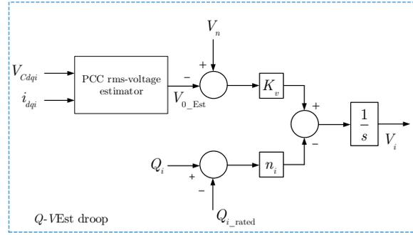
FIGURE 3 : Schéma du contrôleur  $Q - VEst$ .
