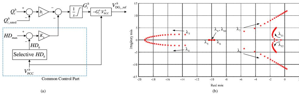
FIGURE 5 : Schéma du contrôleur harmonique droop.
