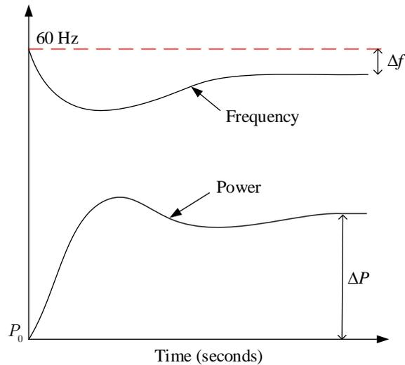
FIGURE 1 : Réponse transitoire d'un générateur synchrone.
