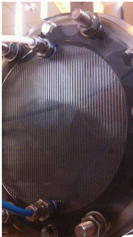
Figure 10: Photo du montage avec la plaque terminale transparente, face plane à l'intérieur, lors d'une mise en eau. Le front est distinguable entre le domaine coloré et le domaine transparent.
