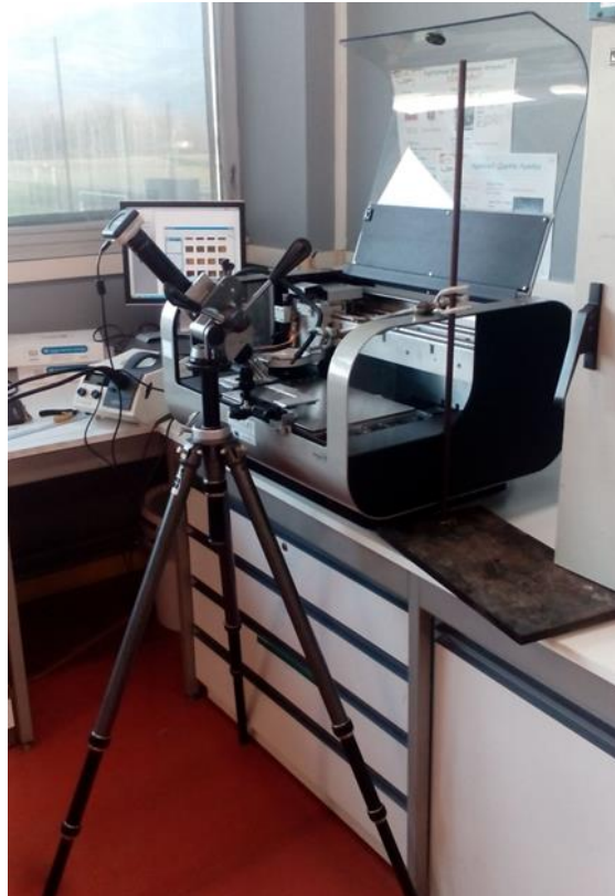
Figure II.15 : Photographie du système d'observation des gouttes après impression
