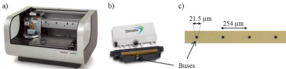
Figure 1: Photographies de (a) l'imprimante Dimatix CMP2831 de Fujifilm, (b) la cartouche et la tête jet d'encre et (c) quatre buses
