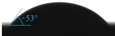
Figure IV.6 : Photographie d'une goutte microvolumétrique d'encre Sicrys™ I30EG-1 présentant un angle de contact de 53^\circ avec le support à l'équilibre
