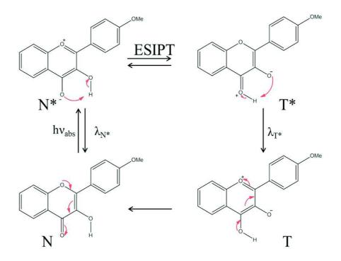
Figure 2-Illustration schématique de la réaction d'ESIPT dans 4M3HF.
