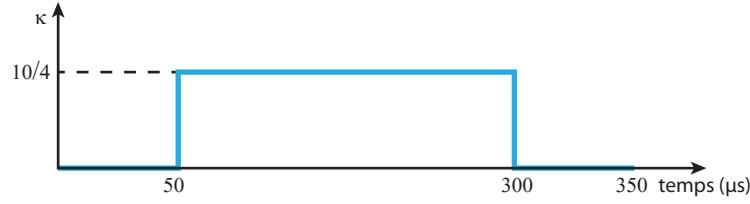
FIGURE 2.9 – Séquence temporelle de variation de \kappa , correspondant à un allumage et une extinction instantanés du réseau optique.
