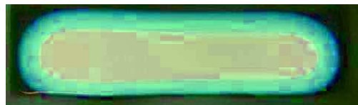
Figure 16: Latex acrylique à particules déformables en cours de séchage. D'après [30].
