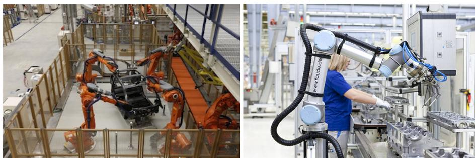
**FIGURE 1.1** – A gauche, un exemple de bras robotiques enfermés dans des cages car il serait très dangereux qu’une personne se retrouve dans leur espace de travail. A droite, un exemple de collaboration entre un bras robotique et une personne.
