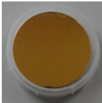
Figure 5-2 : Echantillon de 100 nm d'or sur 3,2 mm de silice
