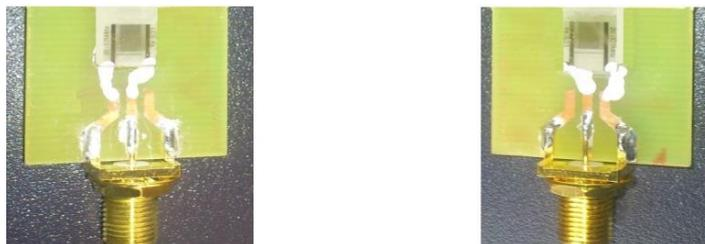
Figure 4-22: Découpe des paires de capteurs IDT
