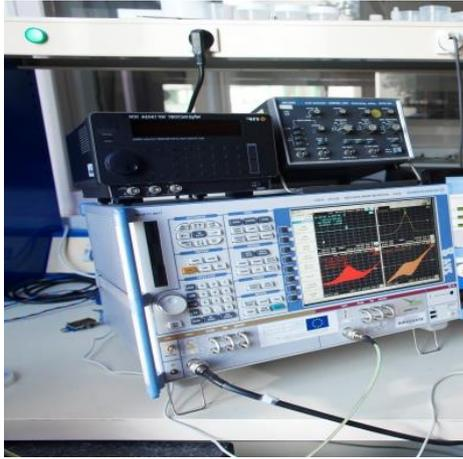
Figure 4-7 : Analyseur de réseau vectoriel
