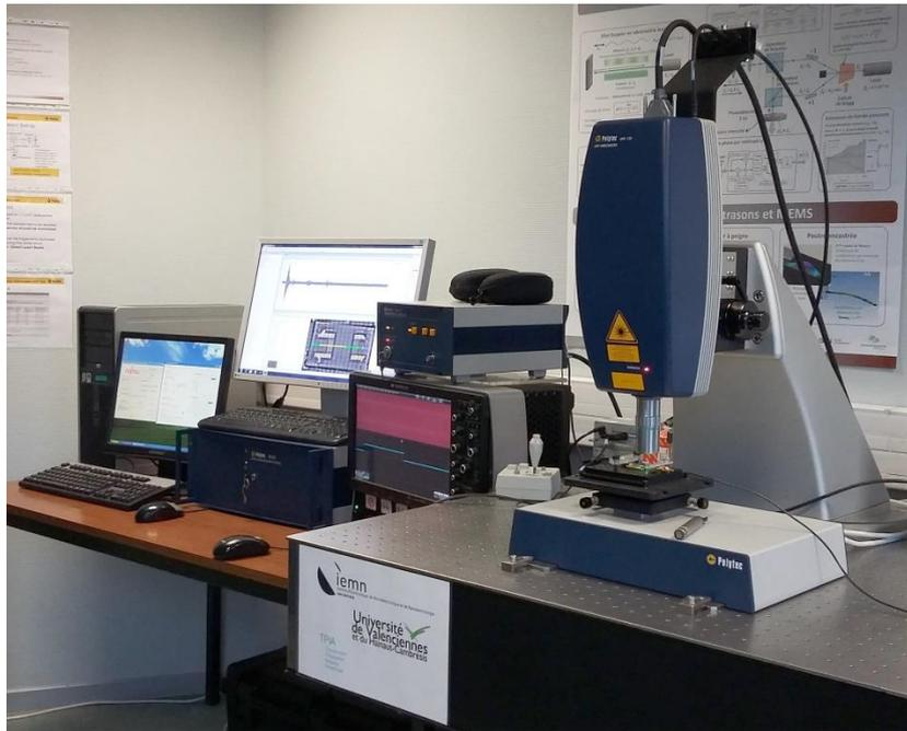
Figure 4-24 : Interféromètre UHF 120
