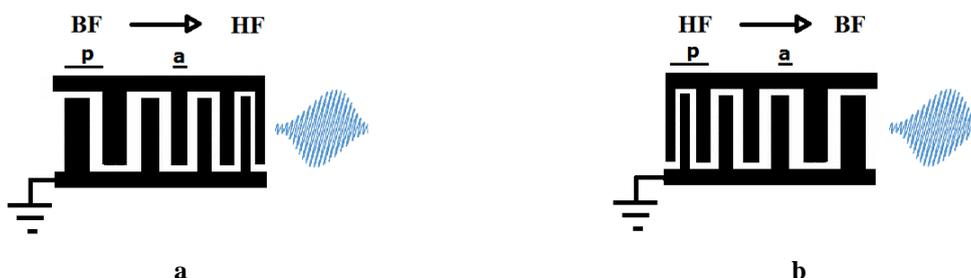
Figure 1-36: Capteur chirp a) up chirp b) down chirp
