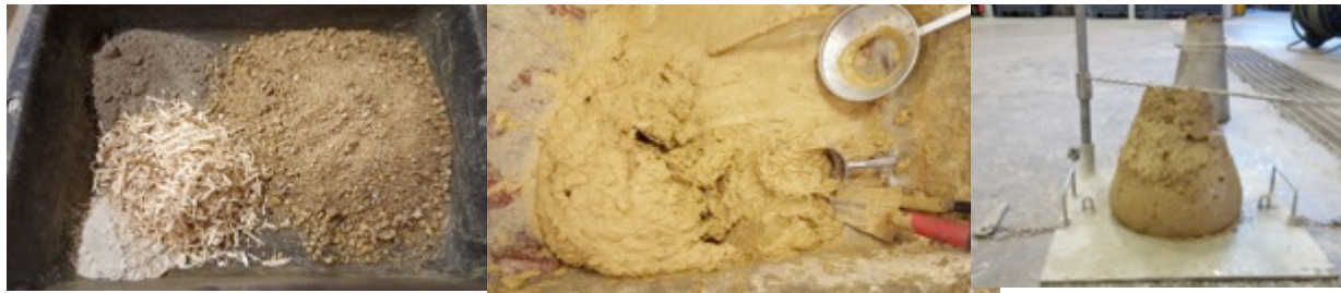
Mesure de l'affaissement à l'aide du cône d'Abraham
