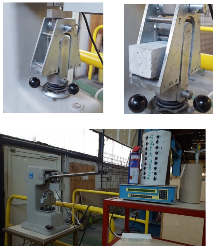
Figure Anex. 4 : Dispositif pour l'essai de flexion
