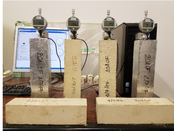
Figure 2. 24 : Dispositif de mesure du retrait.
