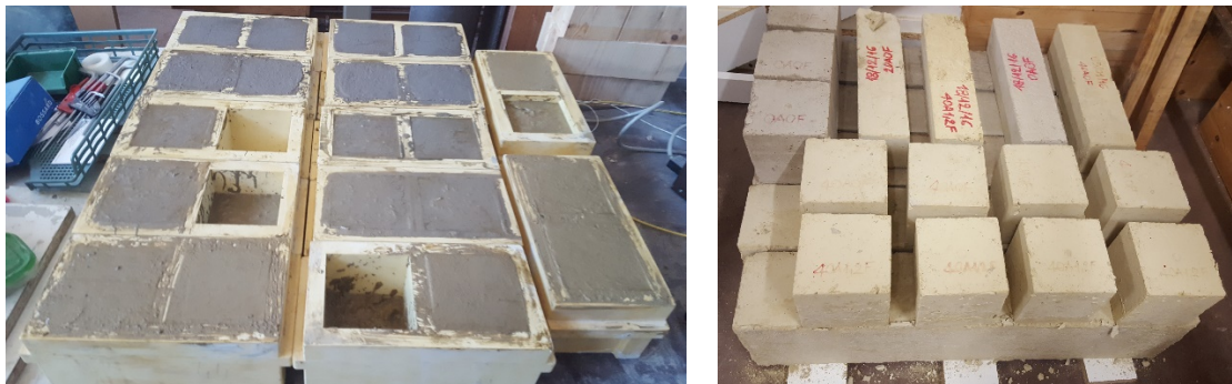
Figure 2. 10 : Eprouvettes (a) après coulage et conservées à l'air libre (b).
