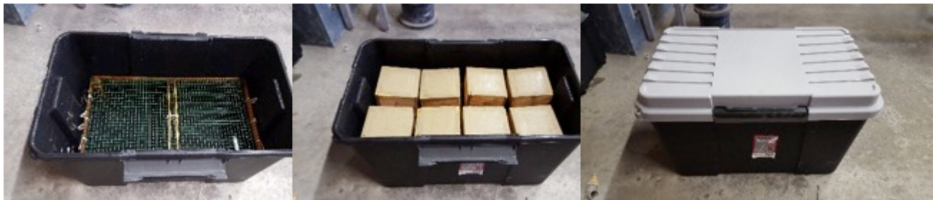
Figure 2. 10 : Eprouvettes (a) après coulage et conservées à l'air libre (b).
