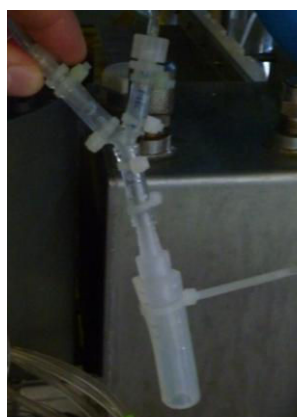
Figure II-11. Té en PEEK et Tygon® permettant la séparation de l'échantillon pompé vers le PEPITO et les Chemini Fe et \Sigma S . Les électrodes sont connectées au niveau de la purge de PEPITO.
