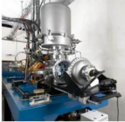
Figure 60 : Photo du dispositif de la microsonde nucléaire utilisée.
