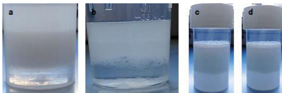
Figure 3-10 : Photographie des essais de formulation à l'UT des émulsions inverses à 50% m de phase aqueuse et 10% m de tensioactif dans la phase huile Pluronic L121 (a) Pluronic P31R1 (b) Brij93 (c) et Tetronic 701 (d).
