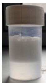
Figure 3-11 : Photographie de l'émulsion formulée à 75% m de phase aqueuse et le tensioactif Span60 à une concentration de 10% m dans la phase huile.
