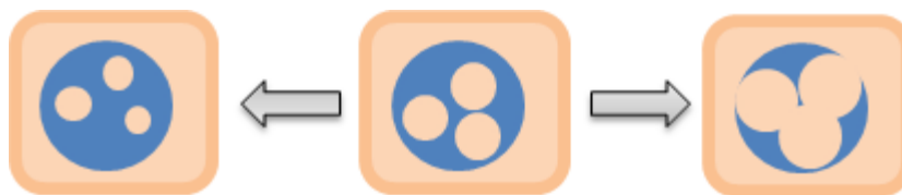
Figure 1-26 : Représentation schématique de la réduction ou du gonflement des gouttelettes.
