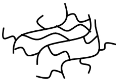
Figure 1-33 : Représentation schématique d'un réseau de polymère réticulé.
