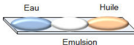
Figure 2-8 : Représentation schématique du test de la goutte.
