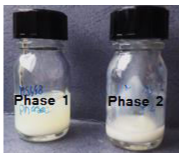
Figure 4-34 : Photographie des deux phases obtenues pendant la polymérisation du système d'émulsions doubles formulé avec 15% m de Méthacrylamide.
