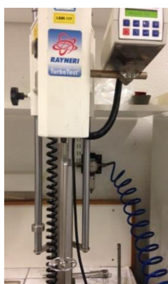
Figure 2-7 : Photographie du mélangeur de laboratoire Rayneri TurboTest.
