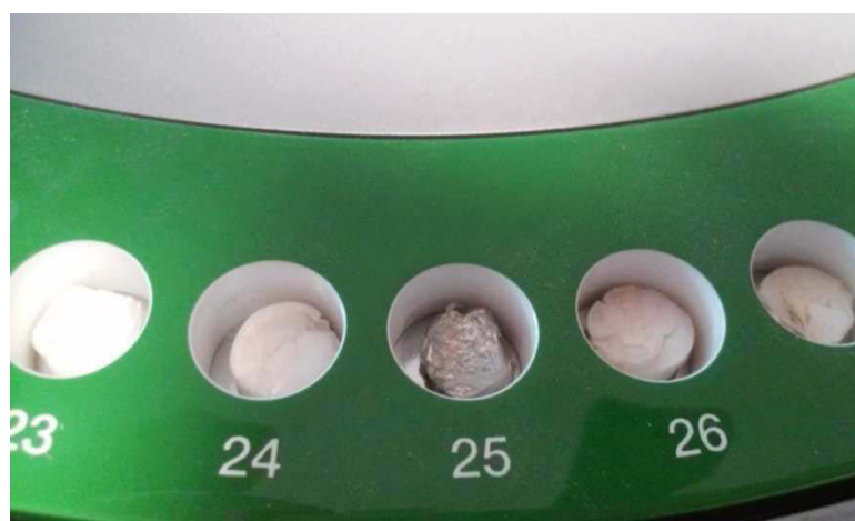
Figure 2. Détermination des matières azotées fécales par l'analyseur Leco FP428
