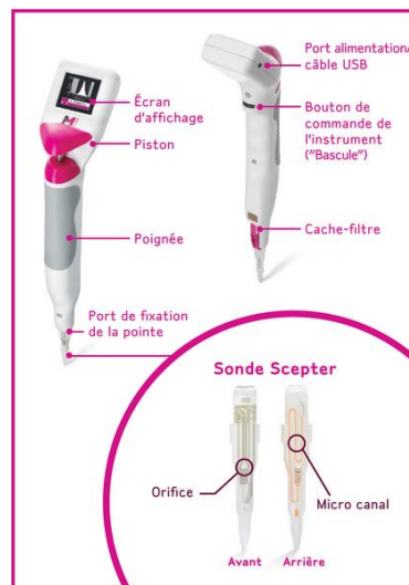
FIGURE 12 UNE PIPETTE DE COMPTAGE DE LA MARQUE SCEPTER BASEE SUR LE PRINCIPE COULTER 9
