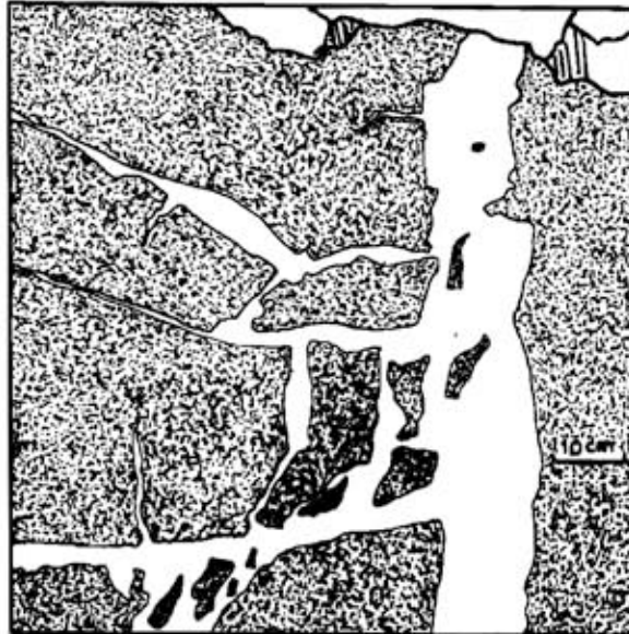
Figure VIII-5: Dolérite de la tête Niqueuse: illustration du mode de désagrégation selon un réseau de filonnets acides de puissance variable, organisés en plans suborthogonaux.
