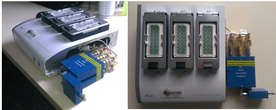
Figure 28. Vue de côté et de face du système xCELLigence modifié afin de permettre de délivrer des RF aux différentes plateformes de mesure.
