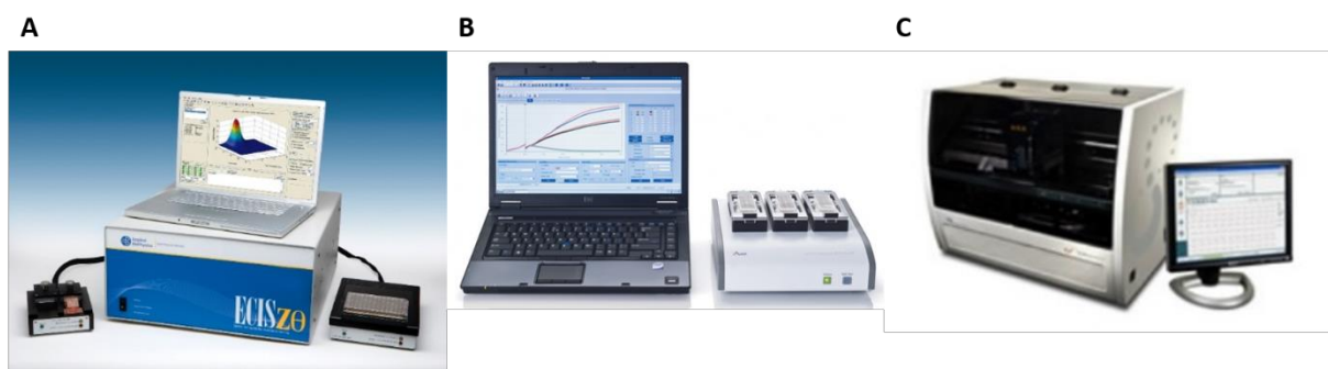
Figure 26. Biocapteurs électriques. (A) Système ECIS de chez Applied Biophysics. (B) Système xCELLigence de chez Roche/ACEA Biosciences. (C) Système Cellkey de chez Molecular Devices.
