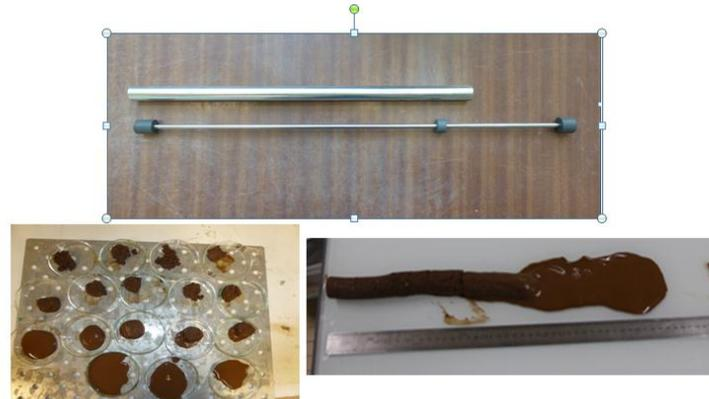
Figure IV-5: Photo du carottier et un exemple d'une carotte prélevée et découpée de la colonne de sédiments sans matières organiques d'âge de deux semaines.
