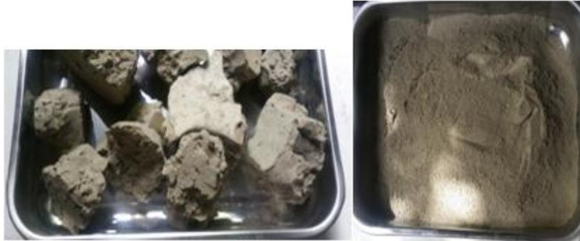
**Figure II-1: Aspect du matériau après séchage à 20°C (à gauche), et après broyage et tamisage (à droite).**
