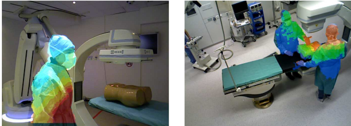
Figure D.7: (Gauche) Visualisation par AR mobile de l'exposition aux radiations des cliniciens lors d'une acquisition PA. (Droite) Visualisation par AR effectuée avec les vues des caméras fixées au plafond de la salle, illustrant l'exposition de deux cliniciens lors d'une acquisition AP.
