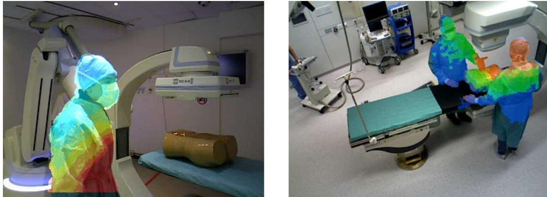
Figure D.7: (Gauche) Visualisation par AR mobile de l'exposition aux radiations des cliniciens lors d'une acquisition PA. (Droite) Visualisation par AR effectuée avec les vues des caméras fixées au plafond de la salle, illustrant l'exposition de deux cliniciens lors d'une acquisition AP.
