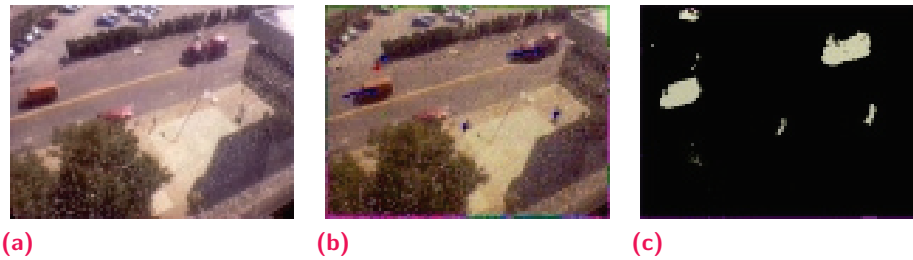
Fig. 2.2.: La soustraction de fond par mélange de Gaussiennes. (a) L'image courante, (b) le modèle de fond, (c) le masque des pixels de premier plan. (Figure 1 de [SG99])
