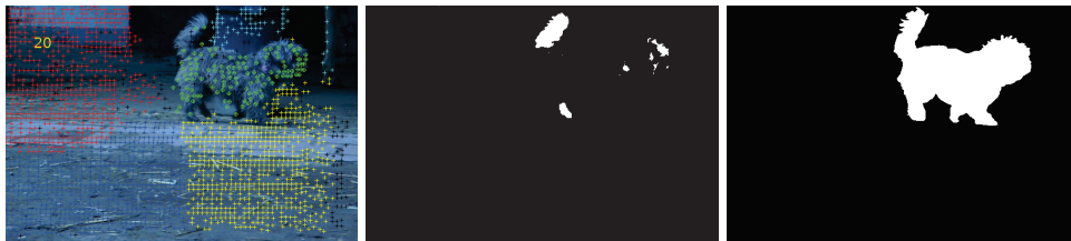
Fig. 4.14.: Erreur d'étiquetage dense avec la méthode d'Elqursh. A gauche, segmentation des trajectoires. Au centre, l'étiquetage dense estimé. A droite la vérité terrain.
