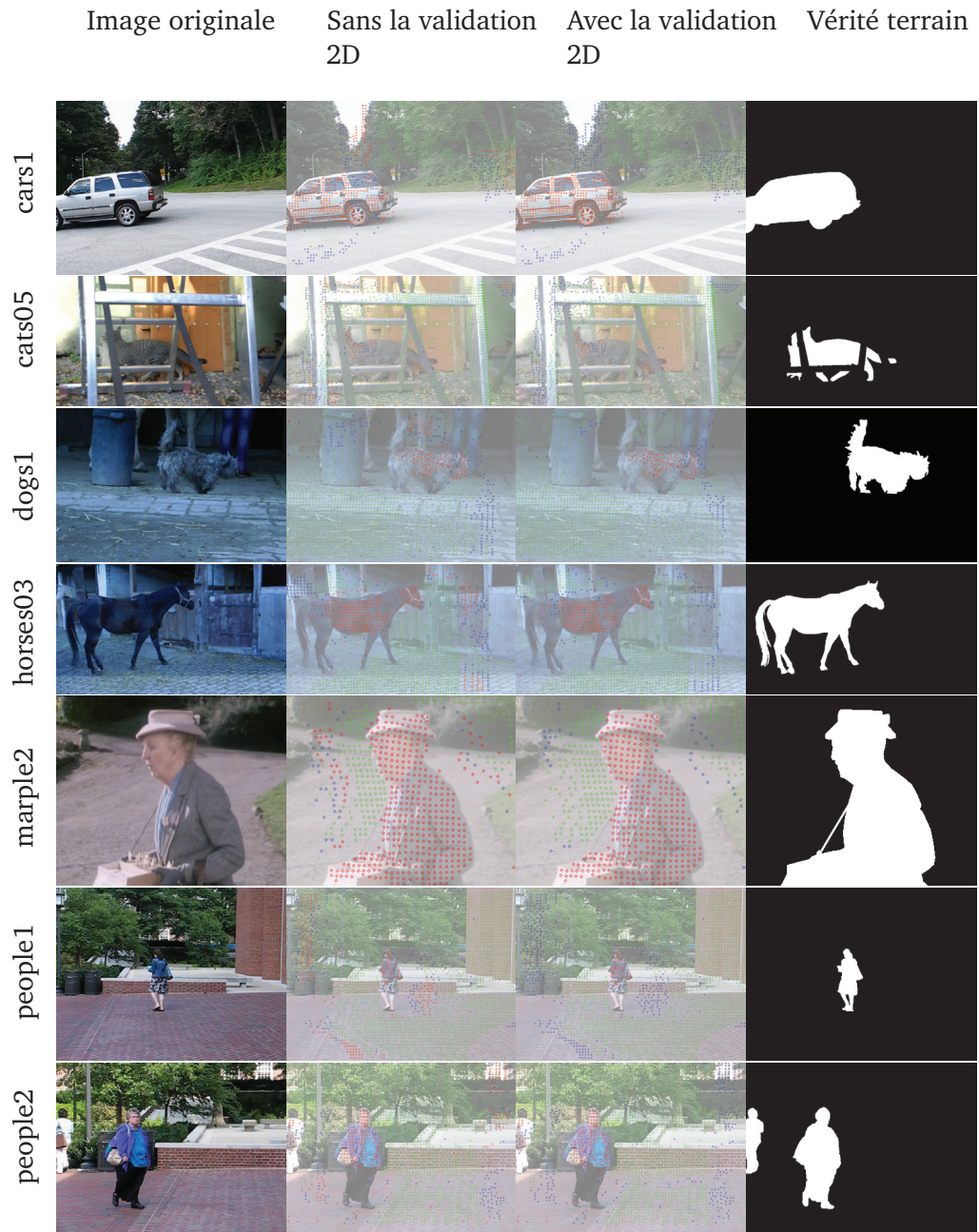
Fig. 4.9.: Résultats de l'étiquetage des points caractéristiques sur des séquences réelles avec et sans l'étape de validation 2D. Les points caractéristiques étiquetés statiques sont affichés en vert, ceux étiquetés mobiles en rouge et ceux étiquetés incertains en bleu.
