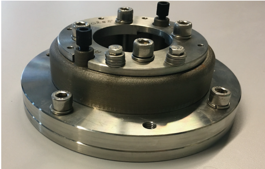
Figure 4.5 : Photographie du premier prototype d'un rotor CPC en acier obtenu par impression 3D (partie en gris foncé, les parties brillantes étant un support pour lester ce rotor dans le bâti)
