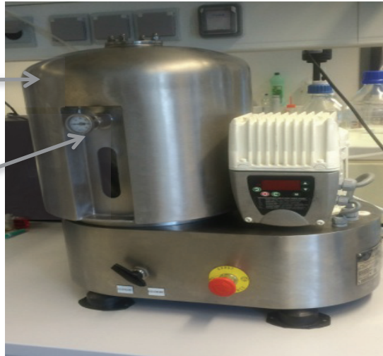
Figure 5.1 : FCPC- C_m C Rousselet-Robatel-Kromaton modifié contenant le rotor mini-3D
