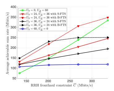
Fig. B.1 Comparaison des débits totaux vs. capacité de fronthaul  $\overline{C}$  pour différentes stratégies de transmission.
