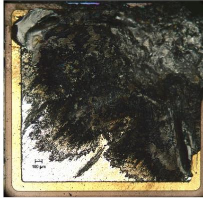
Figure C-30: Défaillance en circuit ouvert d'une diode SiC Schottky (C4D20120A) lors d'un test d'avalanche.  $T_{AV}=240 \mu s$ ;  $E=4.4 J$ ;  $V_{BR}=1800 V$ . Ici, l'essai a été prolongé quelques centaines de  $\mu s$  après la défaillance entraînant un élargissement de la zone affectée.
