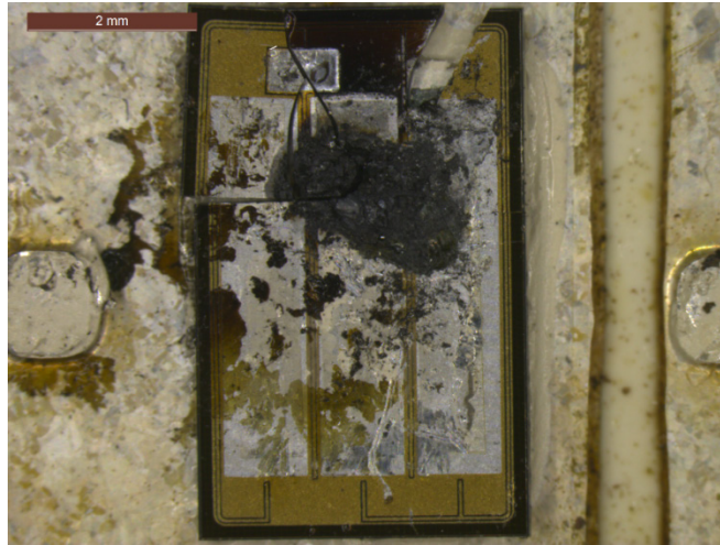
Figure E-40: Vue de la puce défaillante après le test de passage de courant.
