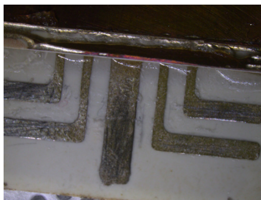
Figure E-27: Vue du gel transparent encapsulant le module Fail-to-short .
