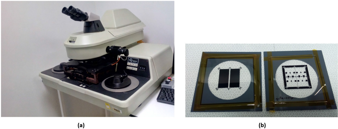
Figure E-8: (a) Photo de la machine de l'aligneur de masques (Q-2001CT)/ (b) Exemples de masques utilisés pour la fabrication du substrat source
