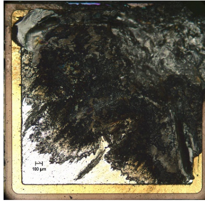
Figure C-30: Défaillance en circuit ouvert d'une diode SiC Schottky (C4D20120A) lors d'un test d'avalanche. T_{AV}=240 \mu s ; E=4.4 J ; V_{BR}=1800 V . Ici, l'essai a été prolongé quelques centaines de \mu s après la défaillance entraînant un élargissement de la zone affectée.
