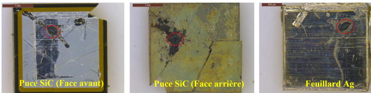
Figure D-18: Photo illustrant le perçage de l'échantillon défaillant (Puce SiC/Feuillard argent) conduisant à un mode de défaillance en court-circuit.
