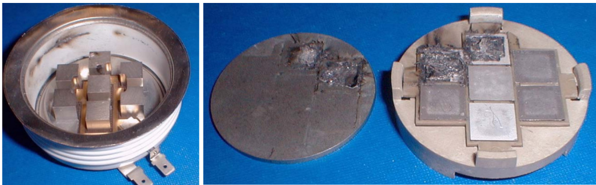
Figure B-37: Exemple de défaillance d'un Module Press-Pack IGBT en court-circuit [55].
