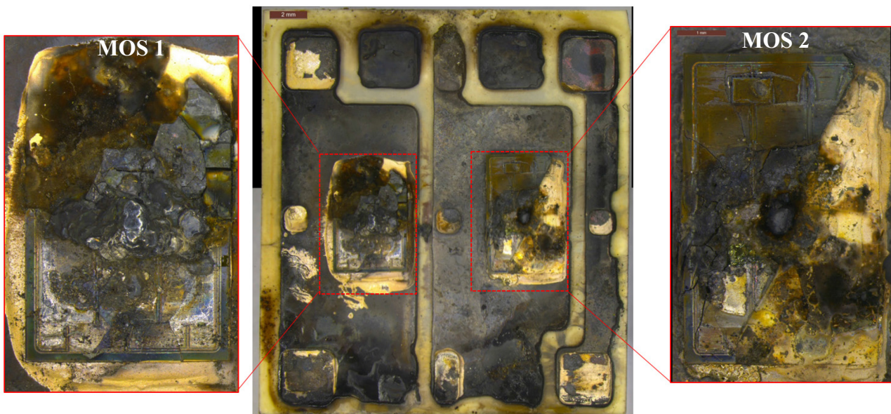
Figure E-33: Vue du substrat “drain” incluant les deux MOSFETs défaillants en régime de sur-courant.
