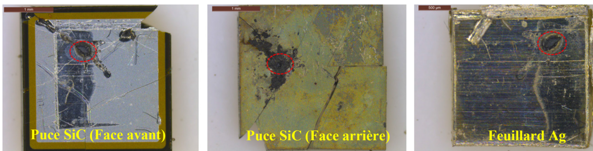
Figure D-18: Photo illustrant le perçage de l'échantillon défaillant (Puce SiC/Feuillard argent) conduisant à un mode de défaillance en court-circuit.
