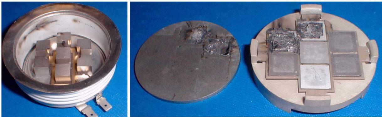
Figure B-37: Exemple de défaillance d'un Module Press-Pack IGBT en court-circuit [55].
