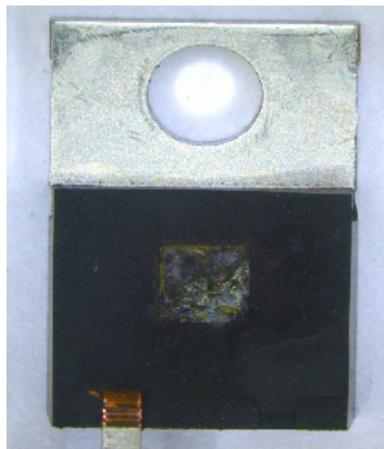
Figure C-25: Photo d'une diode SiC (C4D20120A) après un test en régime de sur-courant.
