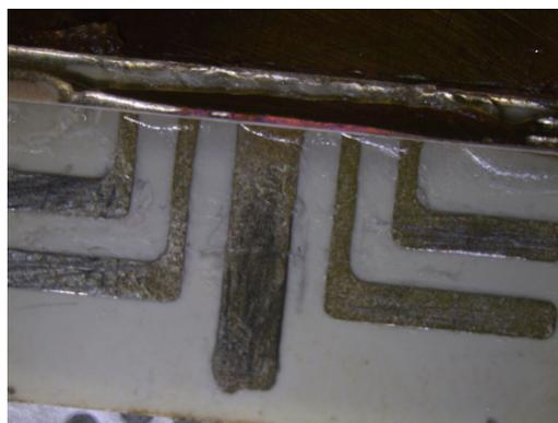
Figure E-27: Vue du gel transparent encapsulant le module *Fail-to-short*.
