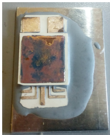
Figure E-41: Photo du démonstrateur Fail-to-short rempli par de la résine époxyde.
