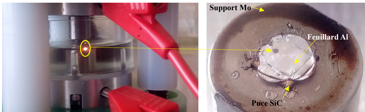
Figure D-26: Vue illustrant la zone de perçage conduisant à un court-circuit entre l'anode et cathode de la puce SiC.
