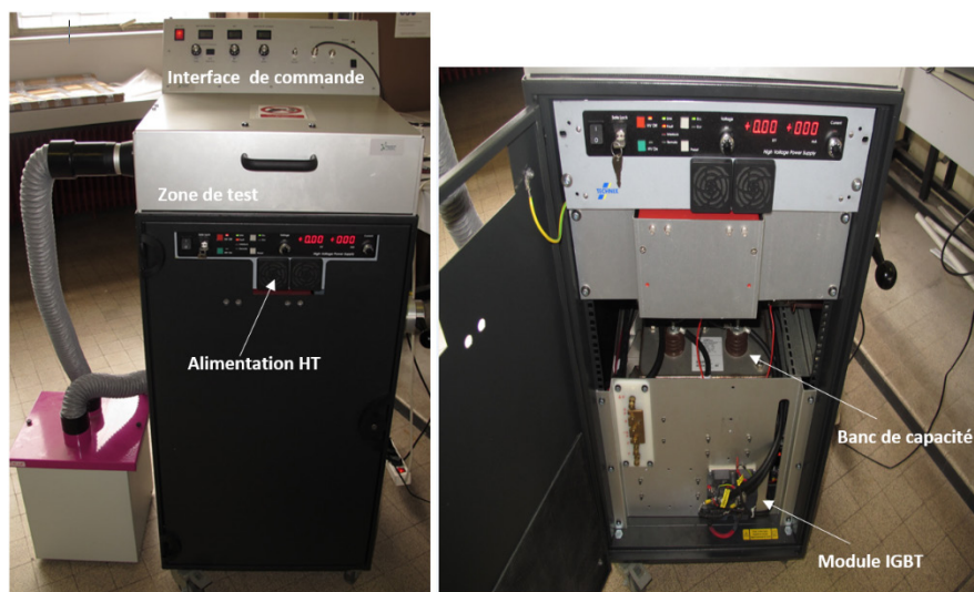
Figure C-8: Photo du banc de test réalisé pour les régimes de fonctionnement extrême.
