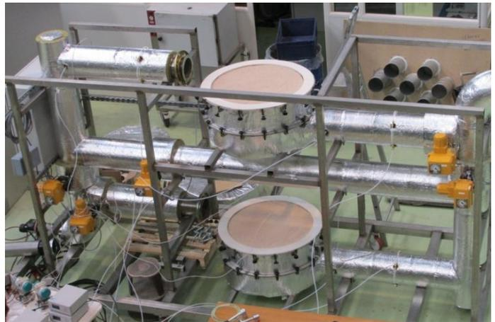
**Figure 3-2 : Prototype du projet STAID, deux modules remplis contenant des grains de zéolite**
