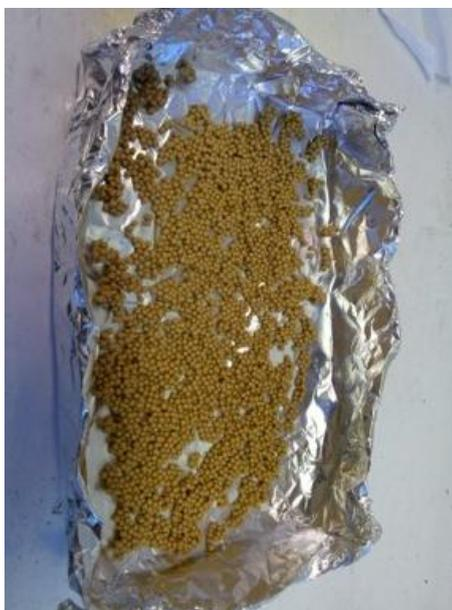
**Figure B-1 : Grains de siliporite saturés en humidité à T ≈ 20°C**
