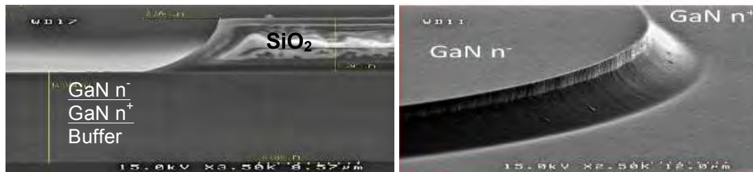
Figure II. 13: Photo de la gravure d'oxyde et mesa de GaN effectuée avec la technique IBE au laboratoire GREMI sur plaque G2ReC [Ohe14]
