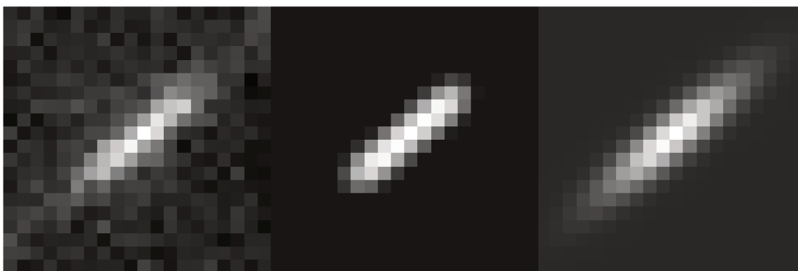
FIGURE 12.6 – Exemple de centroïde ayant échoué au test d'adéquation du \chi^2 . Bien que les modélisations de la gaussienne en mouvement (au milieu) ou de la gaussienne classique (à droite) reproduisent correctement la forme du centroïde réel observé (à gauche), elles échouent au test d'adéquation du \chi^2 à cause de l'influence du fond de ciel.
