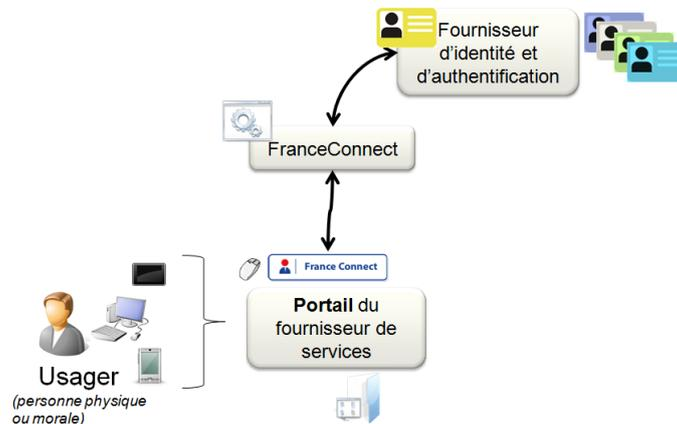
FIGURE 60 – Principe de fonctionnement du France Connect.
