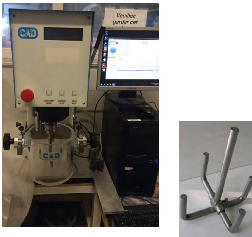
FIGURE II.1 – Rhéomètre RhéoCAD et agitateur à ancre utilisés au LMDC
