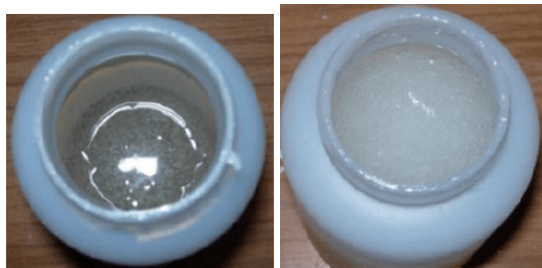
FIGURE III.2 – Aspect des solutions après 24 heures de repos — CMC 3% à gauche, GA 2% à droite
