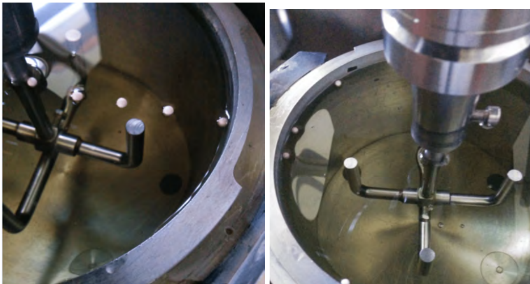
FIGURE III.9 – Positionnement des billes en surface libre avant (à gauche) et après essai (à droite) – solution à CMC 3 %
