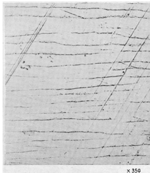
Figure 3-3 : Lignes de glissement horizontales dans un cristal de fer cubique centré [69]
