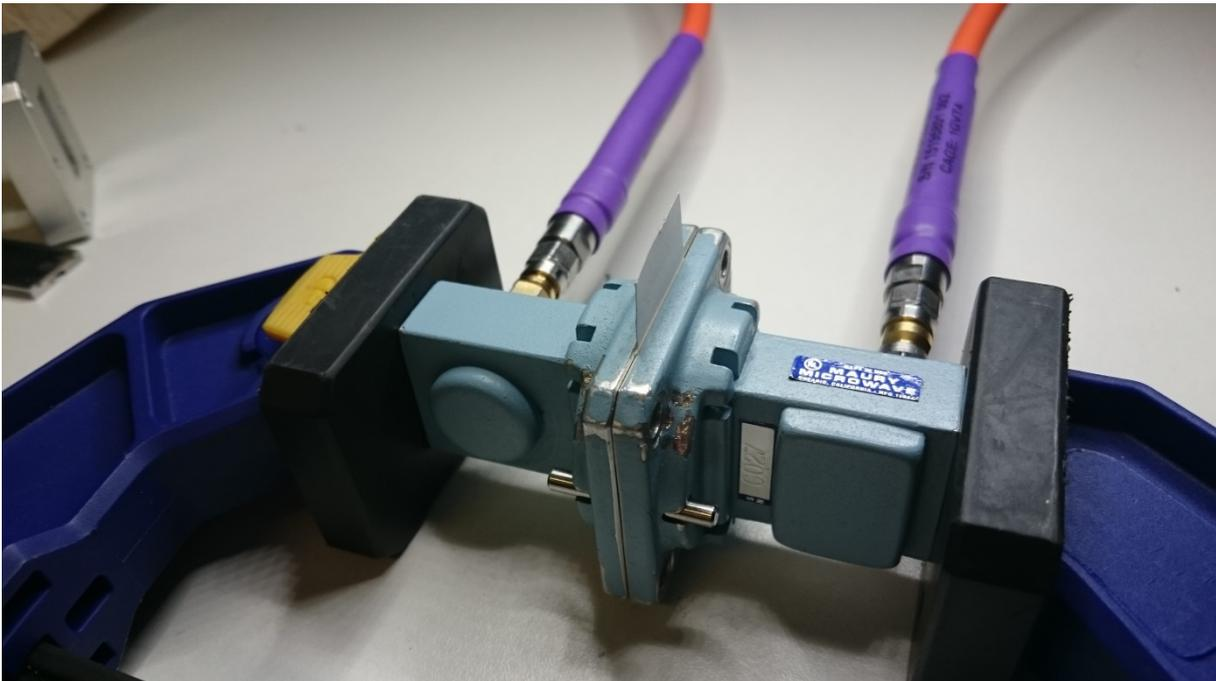
FIGURE 4.15 – Echantillon à caractériser positionné entre les transitions du guide d'ondes rectangulaire.
