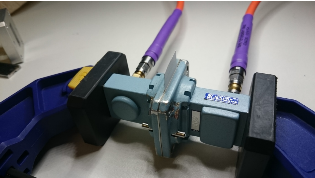
FIGURE 4.15 – Echantillon à caractériser positionné entre les transitions du guide d'ondes rectangulaire.
