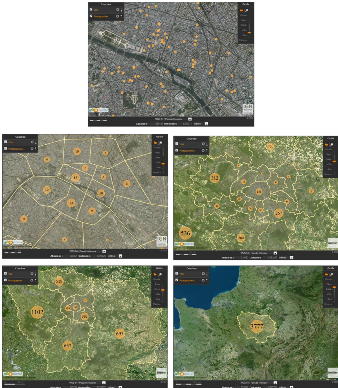
Figure 4.33 Utilisation de la technique d'agrégation par comptage de valeurs distinctes d'une propriété représentées dans des cercles proportionnels pour la visualisation multi-échelle de données thématiques. La propriété sélectionnée dans cet exemple est l'identifiant « ref » des ressources.
