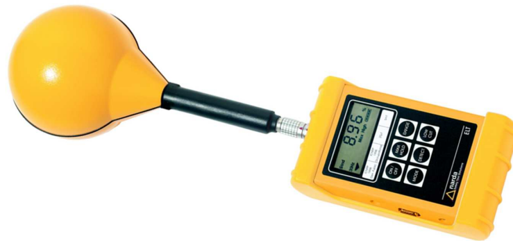
FIGURE 2.3: Champmètre et testeur de niveau d'exposition Narda ELT-400
