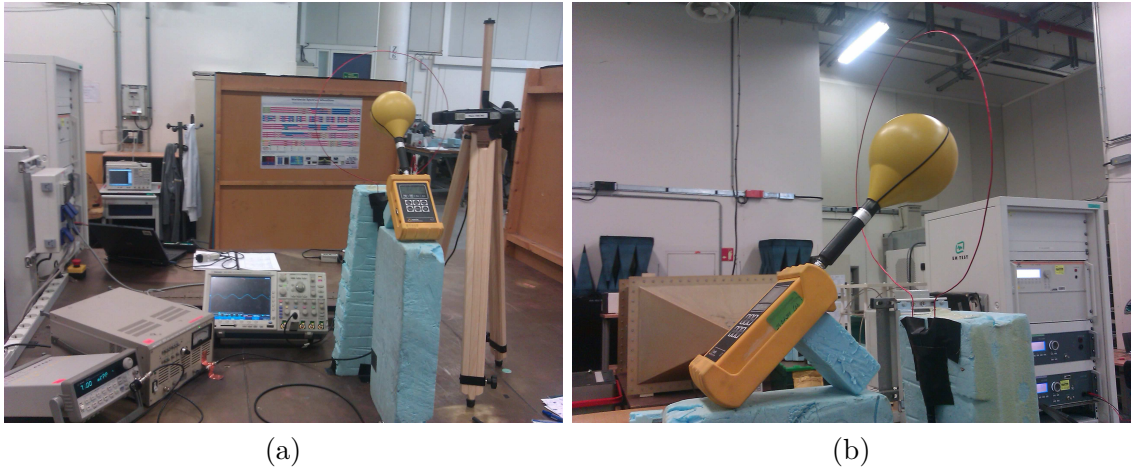
FIGURE 2.7: Configuration de mesure du champ magnétique rayonné sur l'axe de la spire
