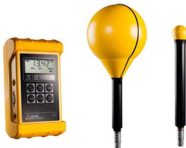
FIGURE 2.2: Différents modules du champmètre et testeur de niveau d'exposition Narda ELT-400
