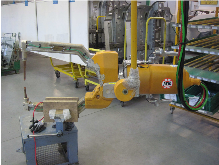
FIGURE 4.1: Première pince à souder à 50 Hz utilisée pour la validation du modèle complet
