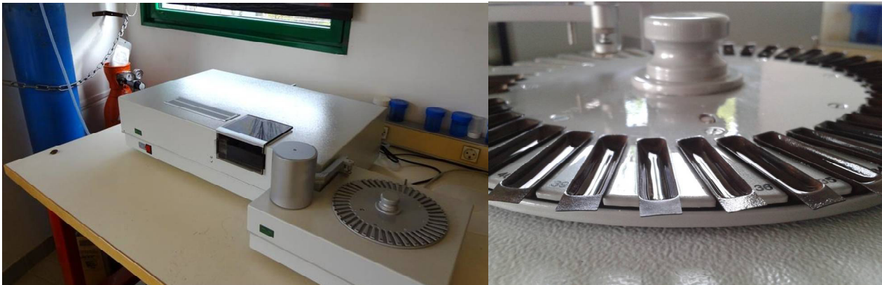
Figure 33: Analyseur de Hg total AMA ( Advanced mercury analyser ) (à gauche). Le plateau de passeur automatique ASS ( auto solid sampler ) remplis par des nacelles en nickel contenant des échantillons liquides (à droite).
