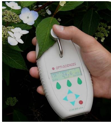
Figure 25: Appareil de mesure de la teneur en chlorophylle, Chlorophyll content meter (CCM).
