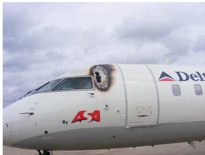
FIGURE 2.4 – Photographie d’un avion de ligne victime d’un impact foudre.
