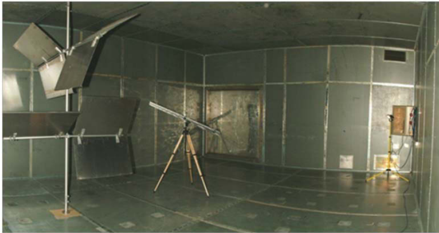
FIGURE 2.3 – Photographie de la chambre réverbérante de l'Institut Pascal [Jan14].
