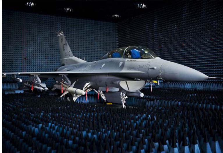
FIGURE 2.2 – Test sur un F-16 de l’U.S. Air Force au sein d’une chambre anéchoïque [For14].
