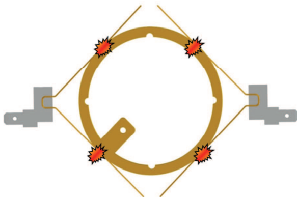
Figure 4 : schéma du contact fil/bague
