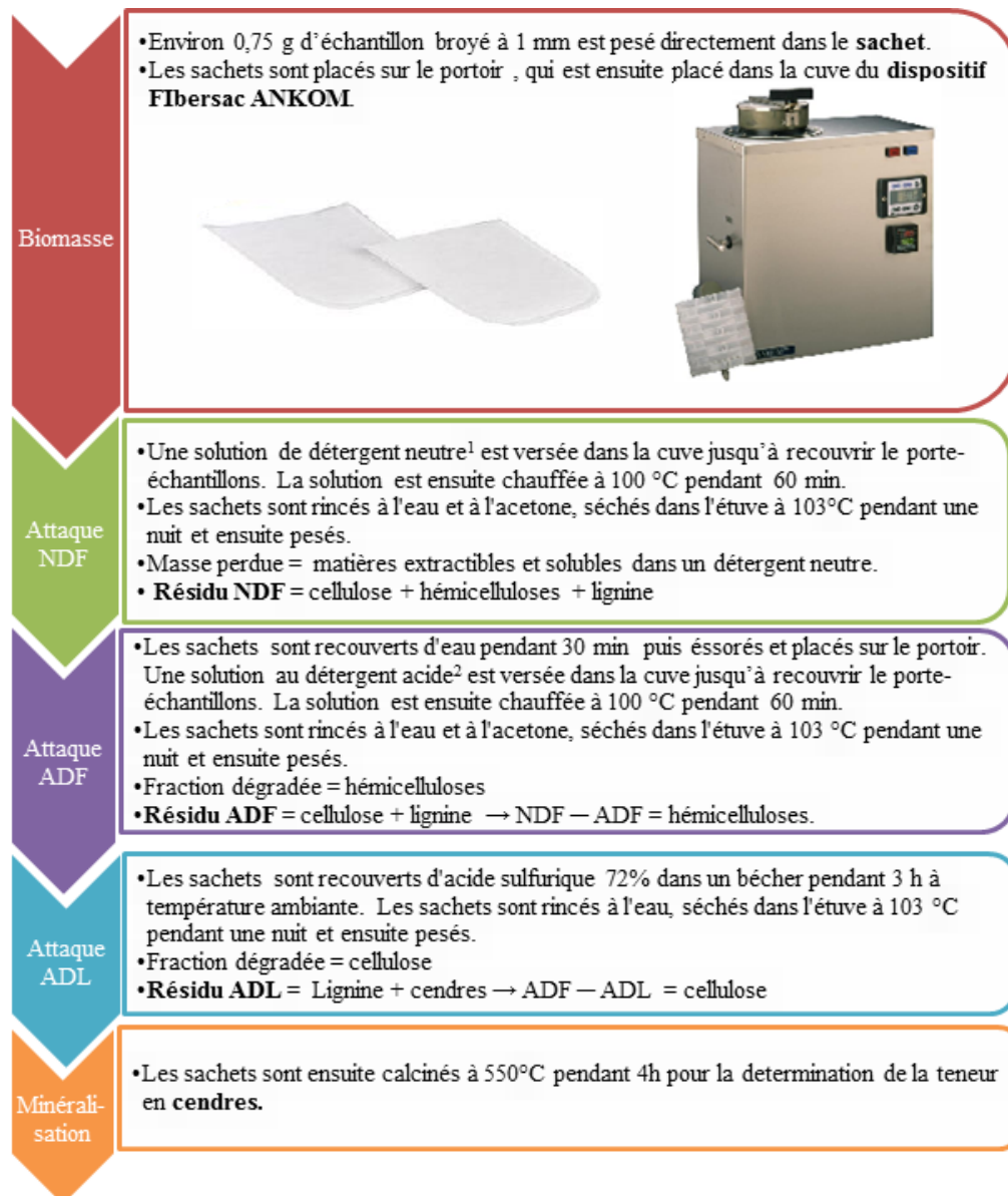
Figure III.3. Schéma de la méthode séquentielle de Van Soest pour la détermination des constituants pariétaux. 1 composée d'eau distillée, de laurylsulfate de sodium, d'EDTA, de borate de sodium, d'hydrogénosphosphate de sodium et de triéthylène glycolde. 2 composée d'acide sulfurique –1 mol/L– et de CTAB).
