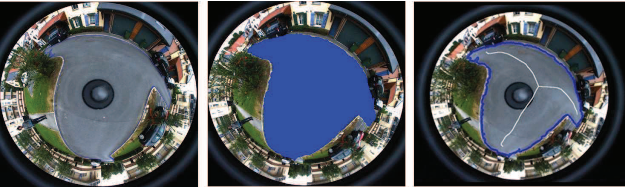
FIGURE 1.7 – Extraction du squelette en utilisant une caméra omnidirectionnelle : image brute (gauche), extraction espace libre en bleu (milieu), extraction du squelette en blanc (droite) [Marie, 2014]
