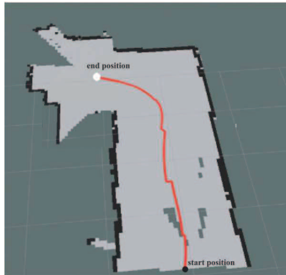
FIGURE 3.18 – Résultats expérimentaux de l'asservissement visuel basé sur le squelette utilisant un fauteuil roulant.
