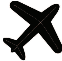
FIGURE 1 – Résultat de l'algorithme de squelettisation : estimation du squelette (trait blanc) pour une forme 2D d'avion
