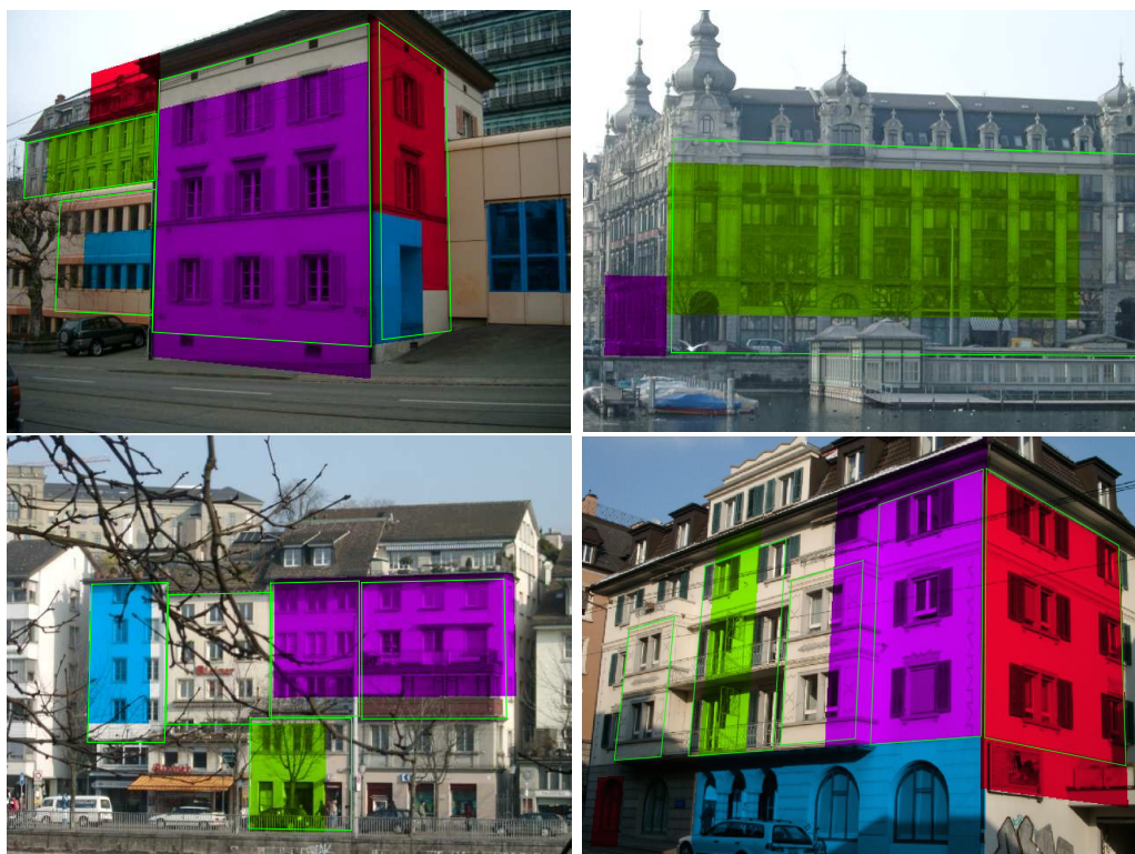
FIGURE 3.25 – Exemples d’échecs dans différents cas de fausses détections. L’image 1 et 2 montrent par de vraies fausses détections respectivement en rouge et en violet. La détection bleue de l’image 1 à gauche est également considérée comme fausse détection car elle est trop petite par rapport à la vérité terrain en traits verts. Sur l’image 3, la détection violette regroupe deux façades de la vérité terrain. Enfin la détection bleue de l’image 4 est une fausse détection consécutive à un oubli de vérité terrain.
