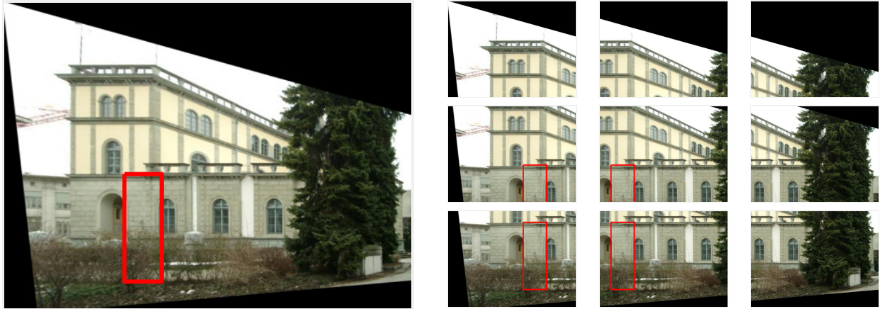
FIGURE 3.5 – Approche multi-résolutions pour le calcul des indices et la détection. À gauche l'image originale rectifiée et à droite les 9 sous-images de dimensions moitiés (zoom).
