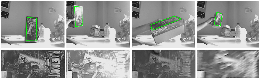
FIGURE 1.2 – Suivi par recalage d'image en utilisant l'information mutuelle comme mesure de similarité entre images [29]. L'homographie entre la référence (en bas) et l'image courante (en haut) est calculée à chaque pas de temps.
