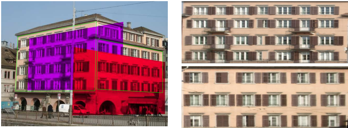
FIGURE 3.26 – Exemple d'échec de la mise en correspondance. La détection violette est correctement reconnue par mise en correspondance avec la façade de référence de la colonne droite en haut. La détection rouge en revanche est aussi mise en correspondance de cette même façade de référence alors qu'elle devrait l'être avec celle de la colonne droite en bas.
