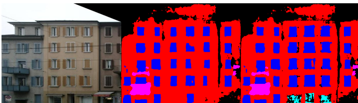
FIGURE 4.20 – De gauche à droite : l’image cible I avec le bâtiment orange comme référence, la segmentation sémantique a priori P(l_j|i, I) , et la segmentation sémantique a posteriori après le recalage. Les 3 portes qui étaient faussement classifiées "façade" et "fenêtre" dans la segmentation a priori sont finalement correctement étiquetés.
