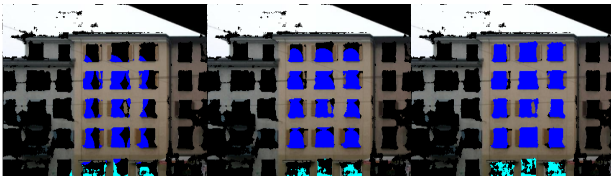
FIGURE 4.19 – Evolution de la segmentation sémantique pendant l’EM sur les 3 premières itérations. Les portes du rez-de-chaussée sont progressivement classifiées en même temps qu’elles aident à guider le recalage.
