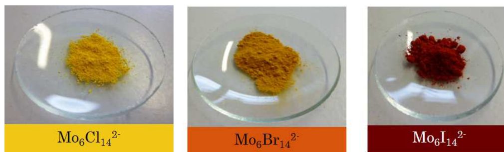
Figure I.6. Photographies des composés Cs_2[Mo_6X_{14}] à motifs [Mo_6X^i_8X^a_6]^{2-}
