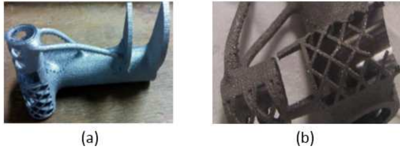
Figure 3-43: (a) Le prototype; (b) La pièce cassée pendant l'usinage
