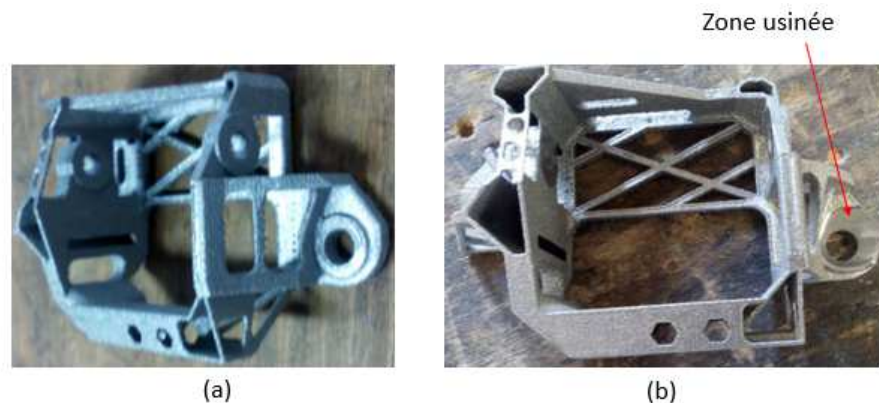
Figure 4-2: (a) Prototype avant finition; (b) Prototype après finition
