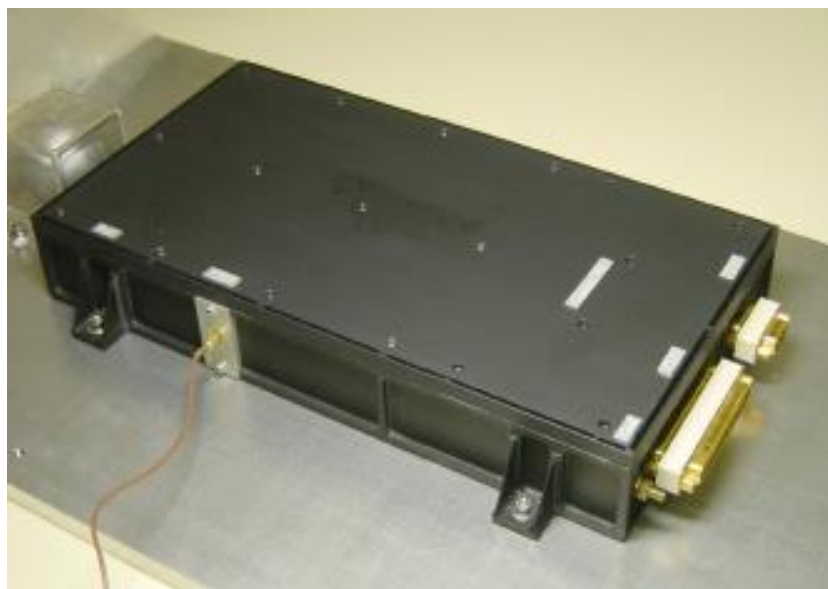
Figure 2.12 : Boîte électronique de CONSERT (Source Consert)
