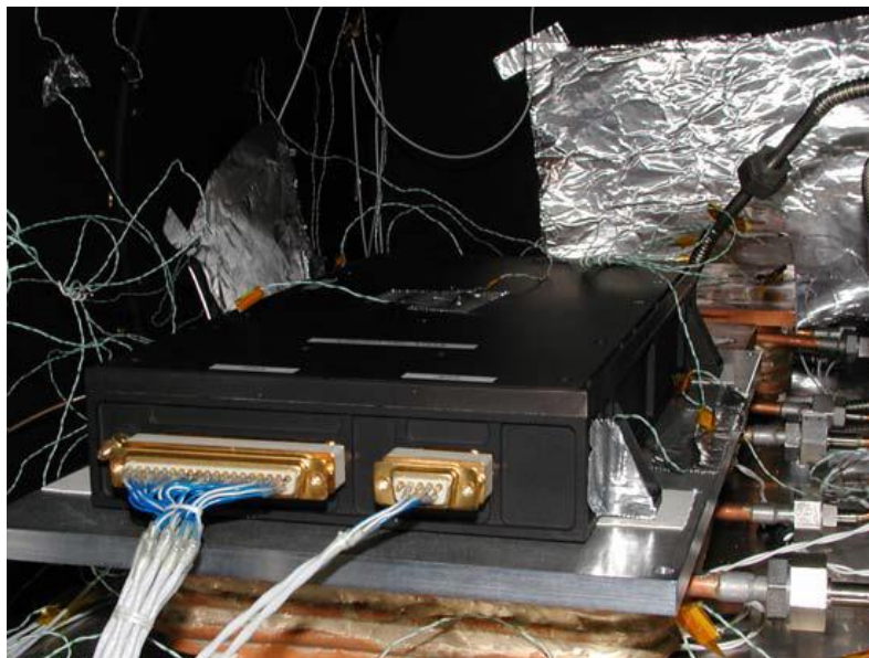
Figure 3.3 : photo prise durant l'installation de CONSERT dans la cuve Mercure des tests thermiques
