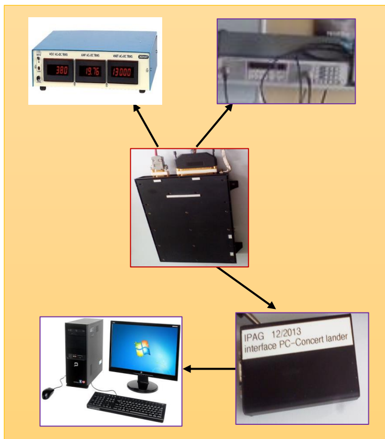
Figure 3.2 : schéma de montage face au banc des tests à vide thermique et calibration
